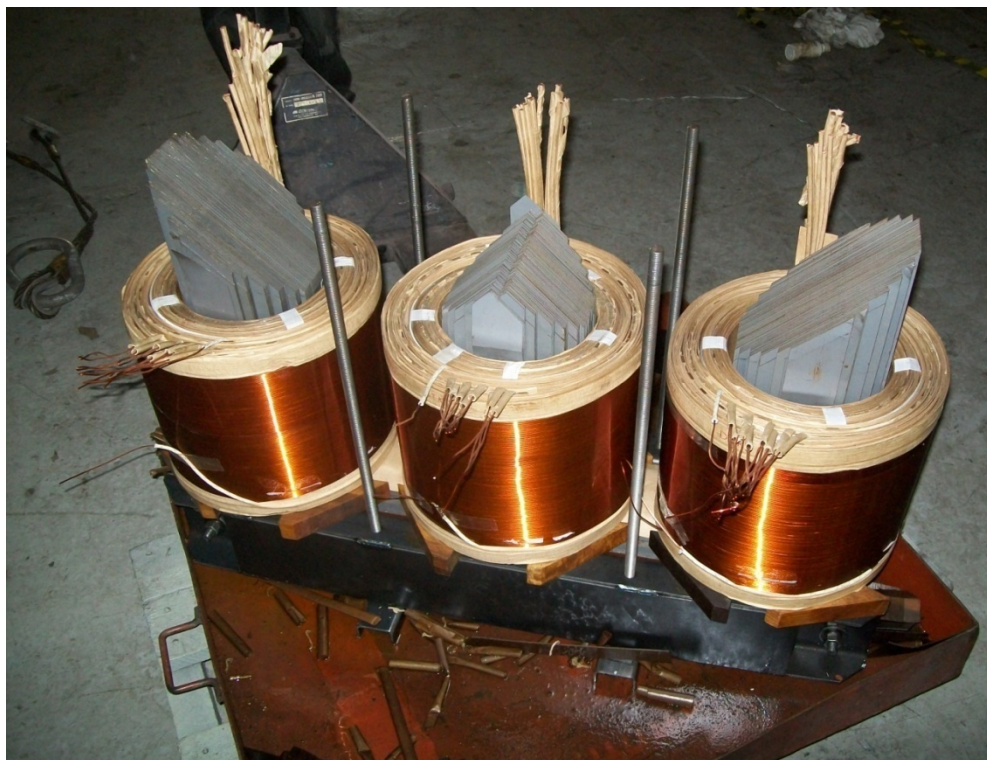
Fig. 3. 17: Foto de núcleo com os respectivos enrolamentos montados.
