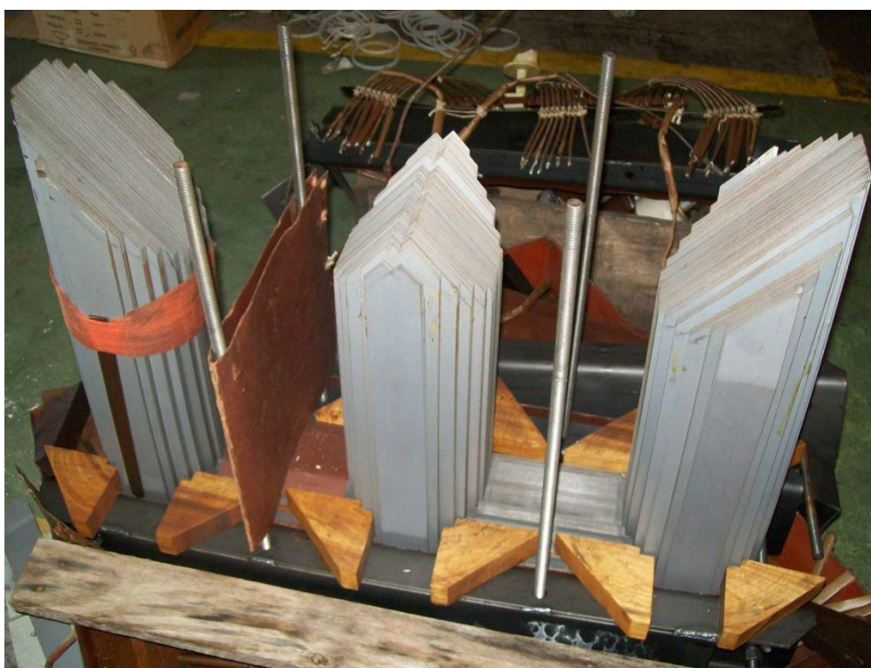
Fig. 3. 16: Foto de núcleo de três colunas com junção de 45°.
