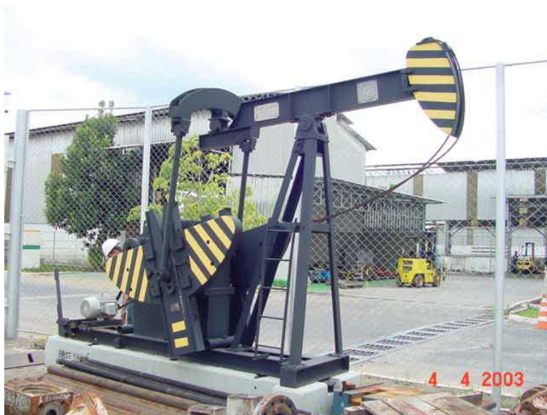
Figura 2.1: Equipamento de bombeio mecânico, BM.
