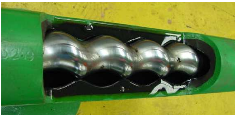
Figura 2.5: Bomba de cavidades progressivas cortada para demonstração.
