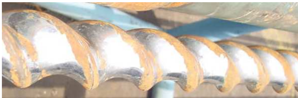
Figura 1.1: Rotor de bomba BCP danificado.
