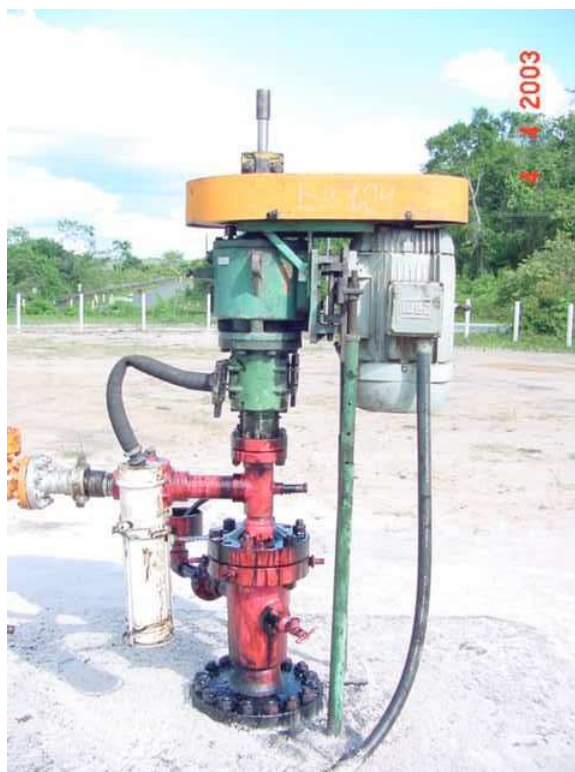
Figura 2.3: Cabeçote vertical de Bombeamento por Cavidades Progressivas, BCP.
