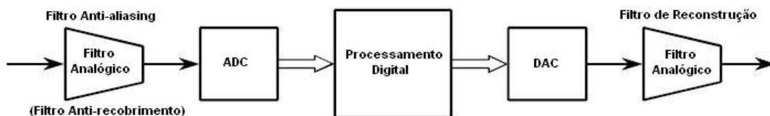
Figura 1.4: Diagrama de Blocos exemplificando um Sistema de Processamento Digital de Sinais.
