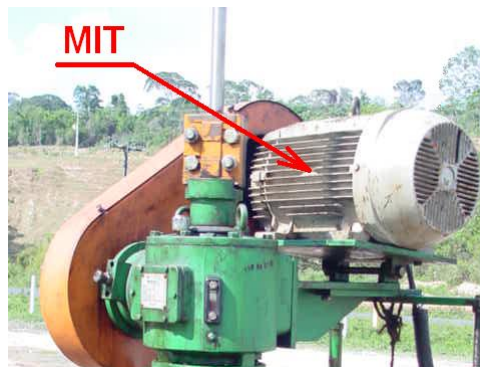
Figura 3.6: MIT de um poço BCP.
