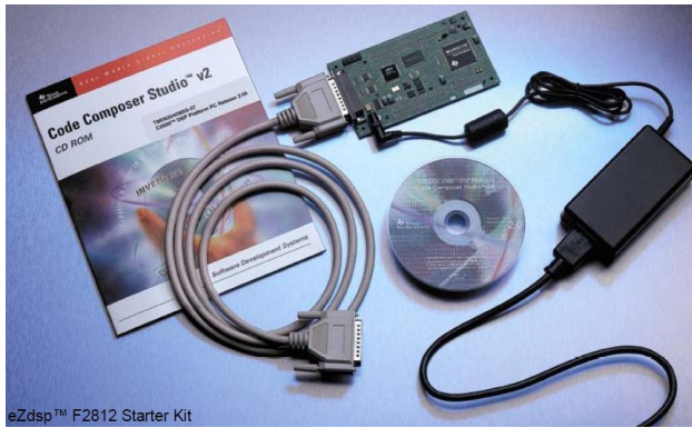
Figura 6.3: Starter Kit eZdsp da Spectrum Digital Inc. para o DSP TMS320F2812 da Texas Instruments.
