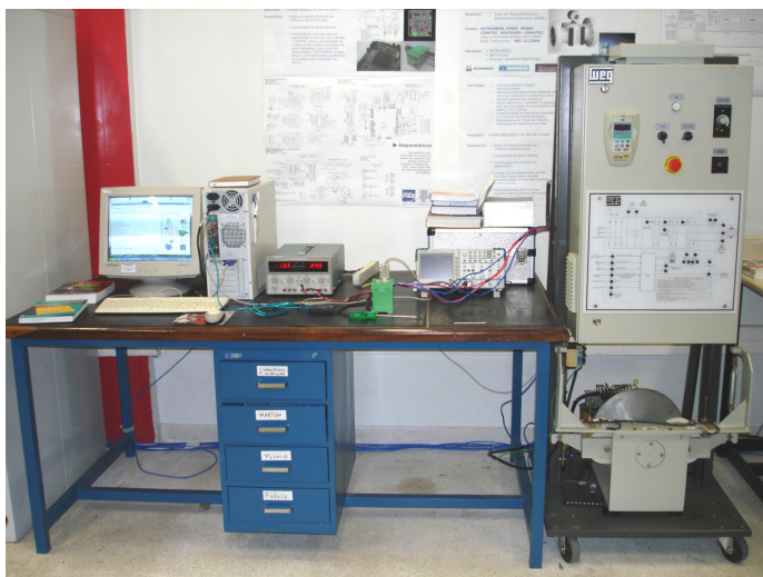
Figura 7.1: Bancada de testes do AMEE utilizada para conceber, testar e validar o protótipo.
