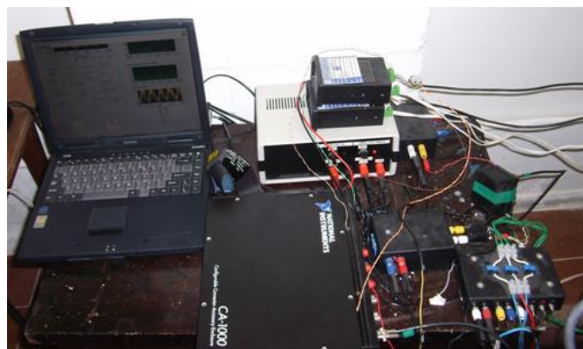
Figura 5.58: Bancada utilizada para acomodar a primeira versão (discreta) dos circuitos eletrônicos para condicionamento de sinais analógicos (excetuando-se o notebook ) na aquisição da corrente do estator do MIT.
