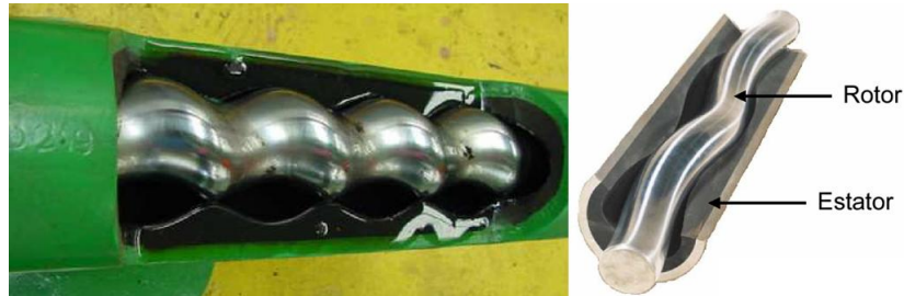
Figura 2.4: Detalhamento da Bomba/Haste no Sistema BCP.
