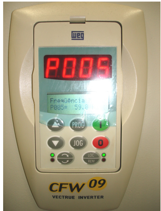
Figura 7.22: IHM do conversor CFW-09 mostrando a frequência fundamental de alimentação f_1 = 59,8 Hz .
