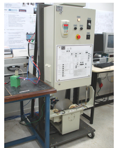
Figura 7.2: Estação didática de ensino do conversor CFW-09 utilizada nos testes.
