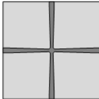
Fig. 5.16: Geometria do guia de ondas de cruzamento otimizado Ponto 1 ( -2,45 \mu\text{m} , 0,20 \mu\text{m} ), Ponto 2 ( -1,61 \mu\text{m} , 0,14 \mu\text{m} ), Ponto 3 ( -0,61 \mu\text{m} , 0,11 \mu\text{m} ), Ponto 4 ( -0,19 \mu\text{m} , 0,12 \mu\text{m} ).
