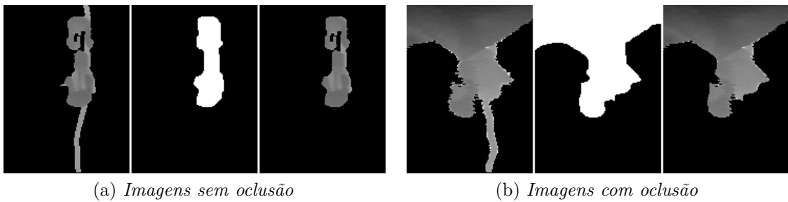
Figura 44 – Imagens do amortecedor de vibração, da esquerda para a direita: imagem original, imagem binarizada, imagem em escala de cinza apenas do obstáculo.
