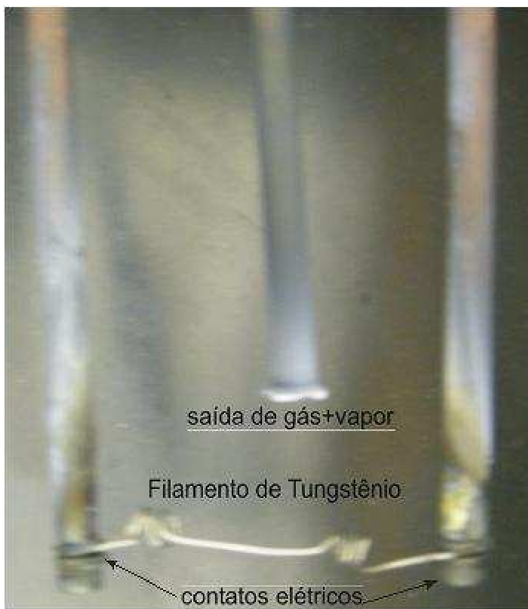
Figura 3.6: Detalhes do reator: resistência de tungstênio que foi utilizada para controlar a temperatura de deposição.
