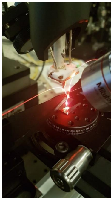
Figura 33. Detalhe da mesa de microposicionamento contendo a amostra com as estruturas, fibras de entrada e saída do feixe óptico. O feixe gerado pelo laser de supercontinuum também possui componentes na faixa do visível.
