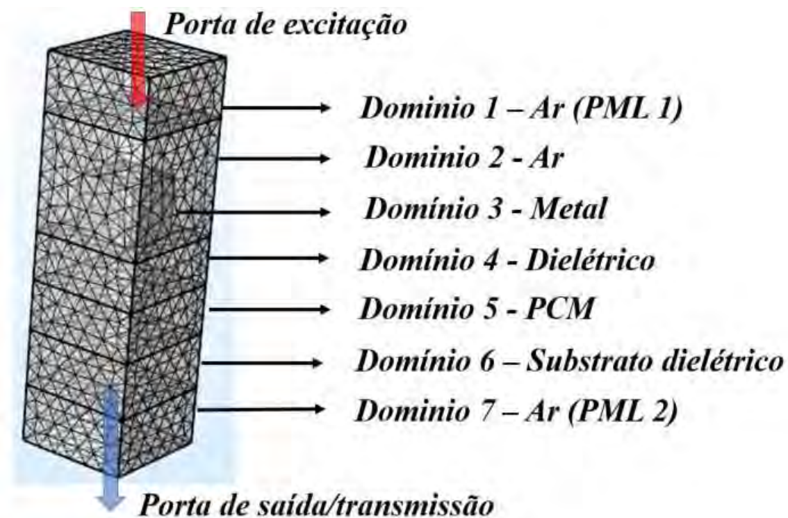
Figura 11 - Discretização da célula unitária de um absorvedor em 3D
