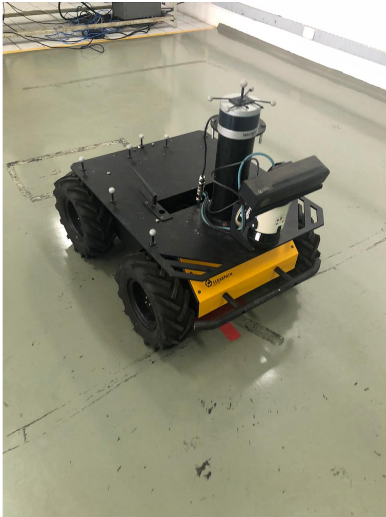
Figura 4.5: Robô Husky equipamento com sensor LiDAR Velodyne VLP-16 e marcadores esféricos para estimativa de pose pelo Optitrack .
