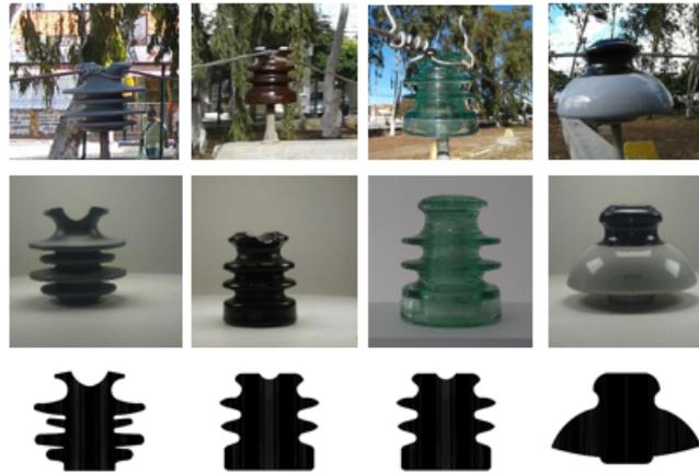
**Figura 26** – Amostras de isoladores, locais de instalação e respectivo desenho de referência da esquerda para a direita: polimérico [IPL], porcelana [IPN], isolador de vidro [IVD] e saia baiana [ISB].
