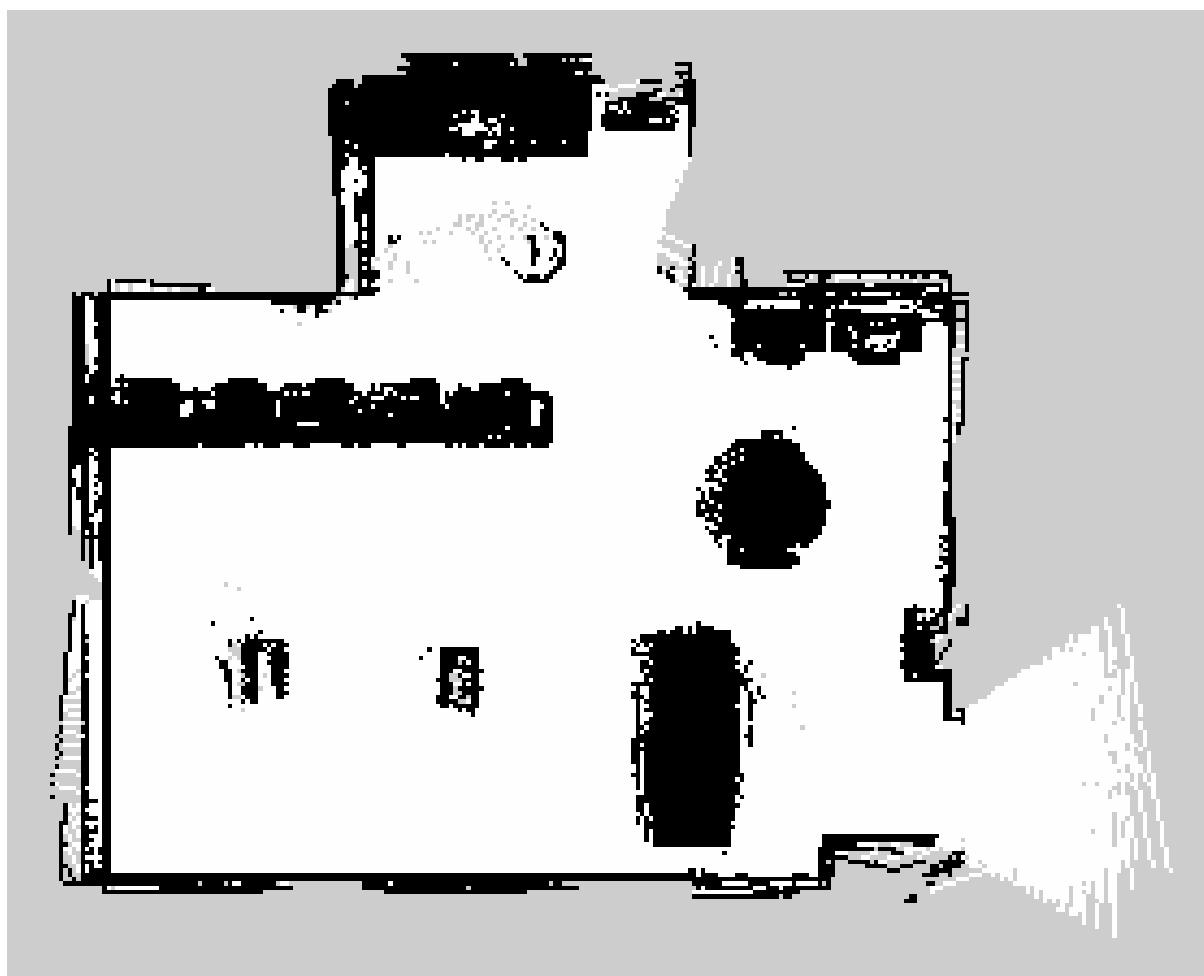
Figura A.15: Mapa da sexta volta em simulação usando os sensores LiDAR + RGB-D e pacote RTAB-Map. Fonte: Próprio autor.
