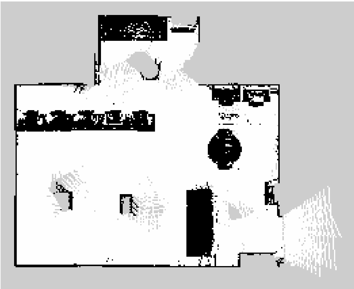
Figura A.10: Mapa da primeira volta em simulação usando os sensores LiDAR + RGB-D e pacote RTAB-Map. Fonte: Próprio autor.
