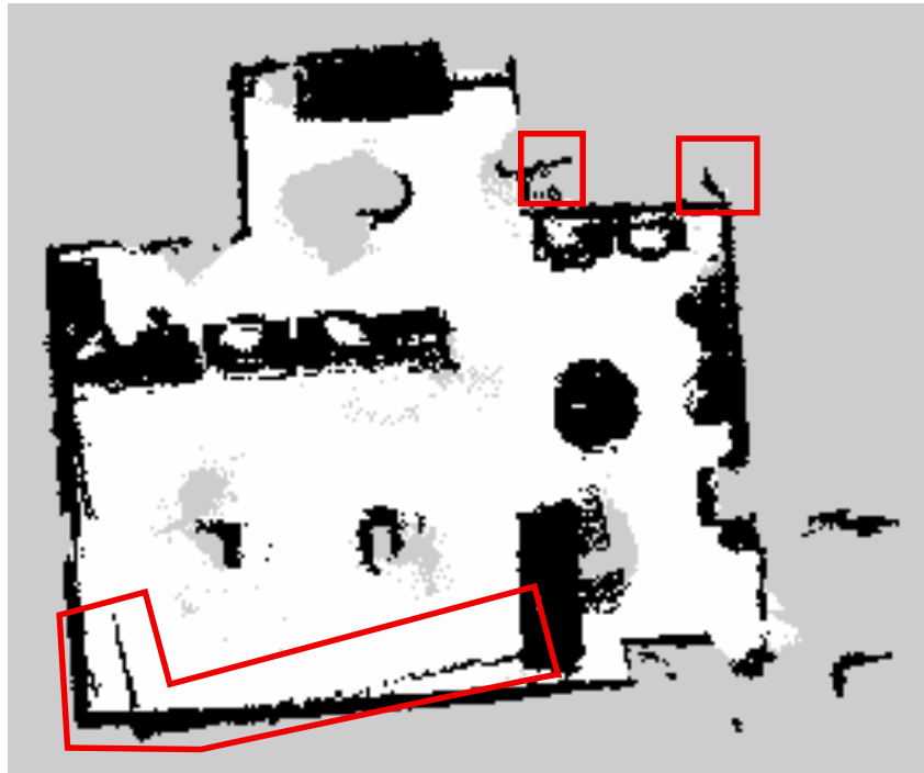
Figura 3.4: Erro no mapeamento ao se utilizar o processo de integração da posição como fonte de odometria.
