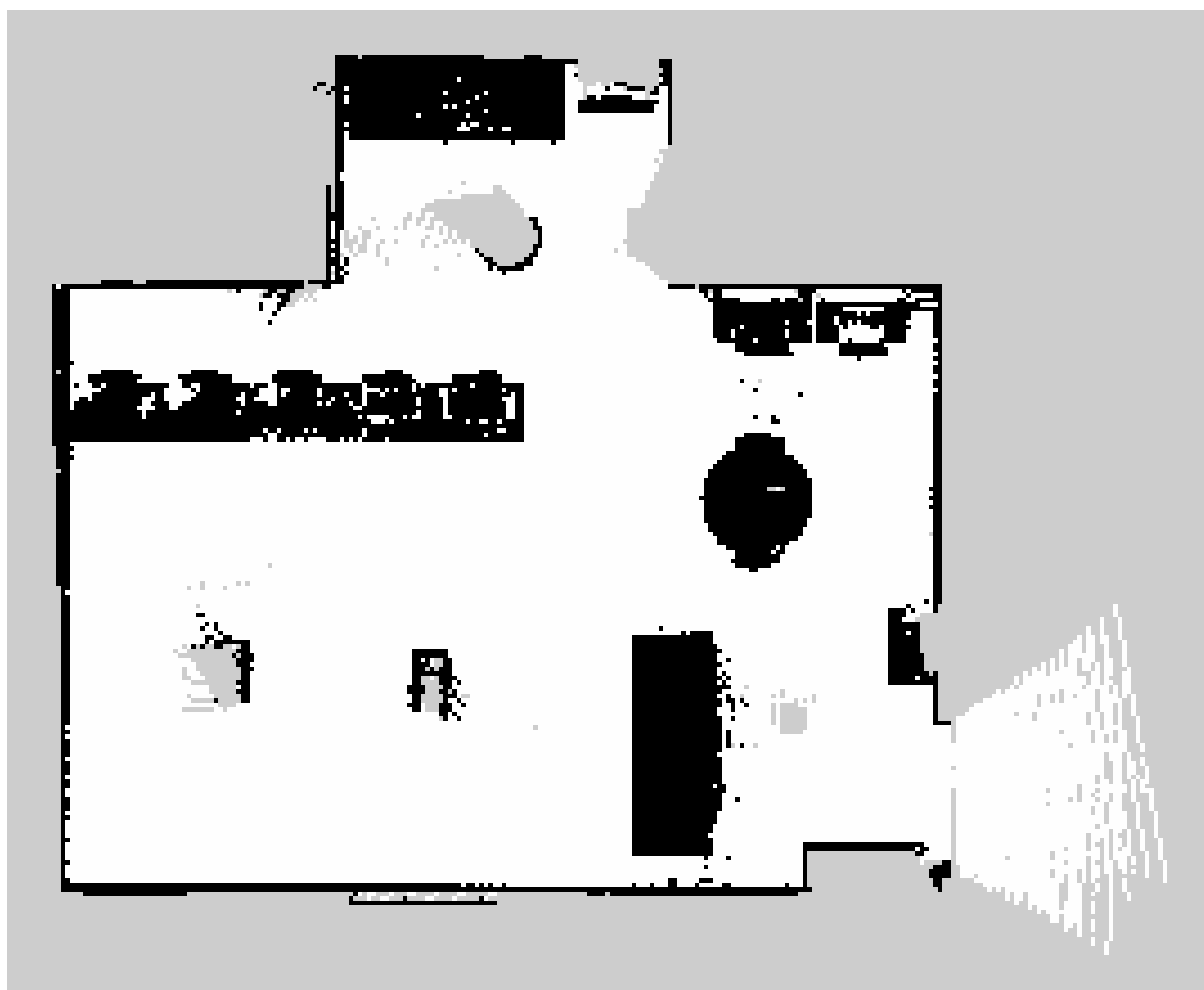
Figura A.11: Mapa da segunda volta em simulação usando os sensores LiDAR + RGB-D e pacote RTAB-Map. Fonte: Próprio autor.
