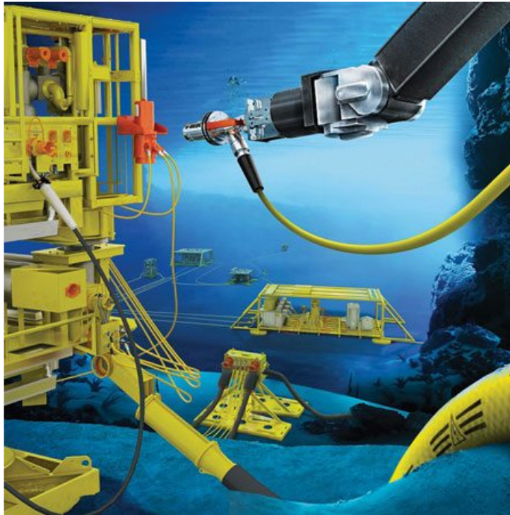
Figura 2 – Acoplamento de conector elétrico submarino com ROV.
