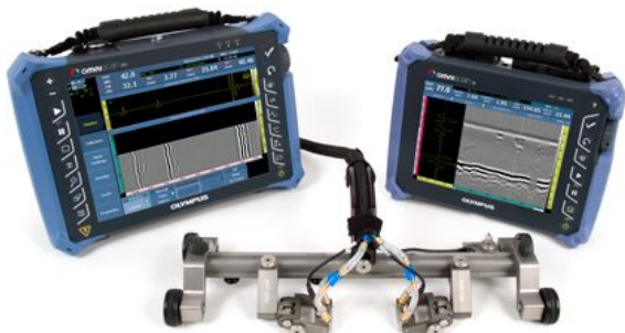
Figura 2.2. Equipamento que permite a aplicação da técnica TOFD.
