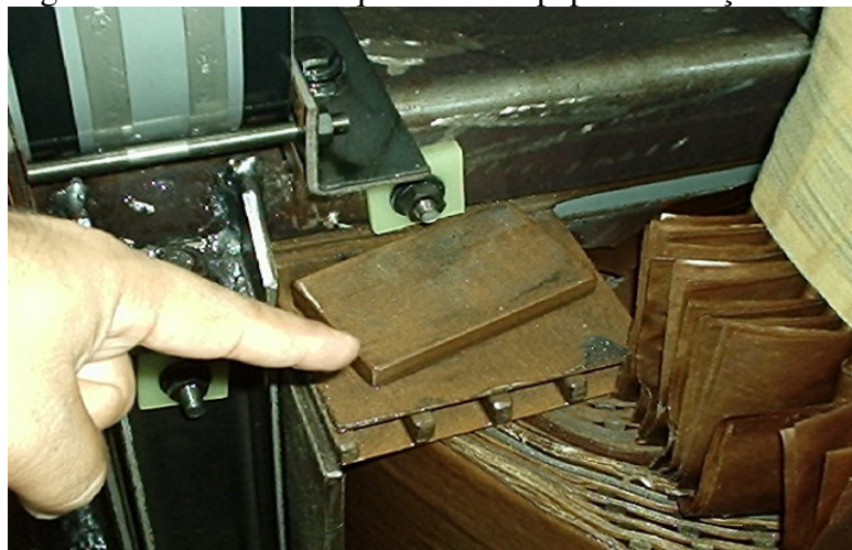
Figura 2.10 - OLTC no qual existem papelão e calços soltos
