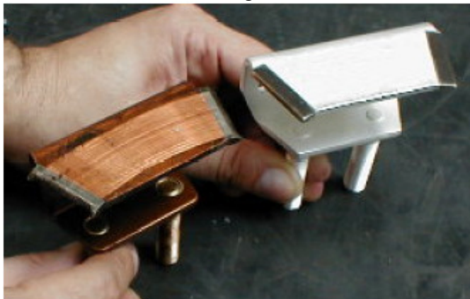
Figura 2.3 - Comparação entre contato desgastado (esquerda) e contato não desgastado (direita)
