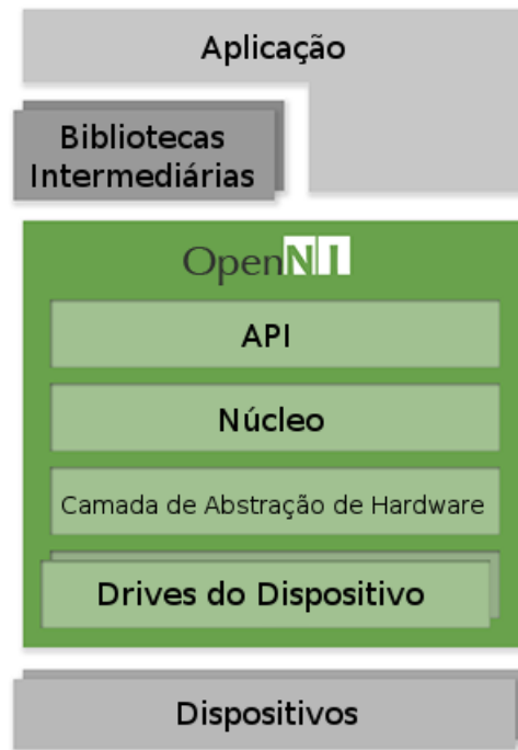
Figura 5.7: Arquitetura das bibliotecas de software OpenNI (PrimeSense, 2011).
