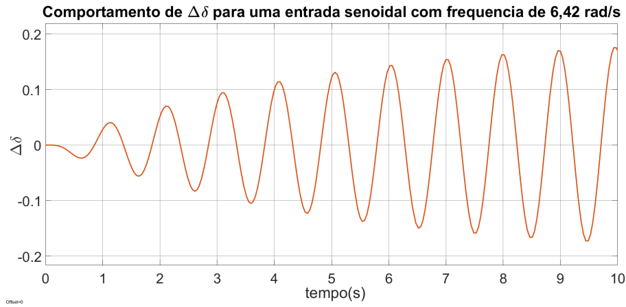
Figura 6.5 – Comportamento do ângulo de carga \Delta\delta para uma entrada senoidal com amplitude 0,01 p.u. e frequência angular de 6,42 rad/s.
