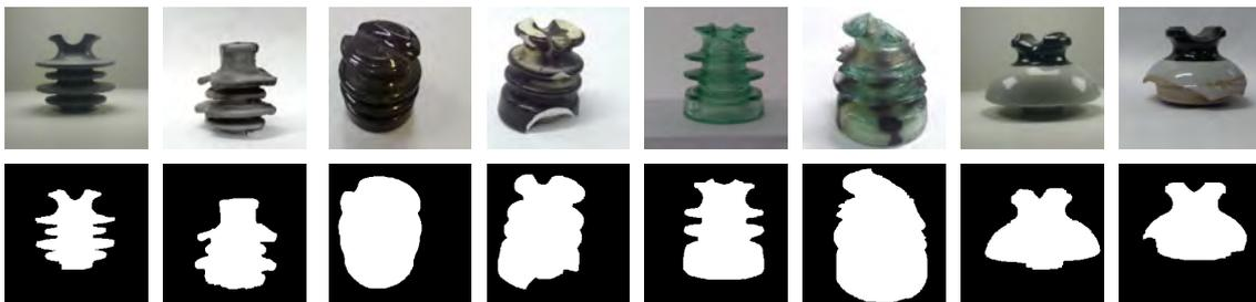
Figura 4.12: Imagem do dataset ECI (parte superior) e máscaras produzidas com a técnica *Graph Cut* (parte inferior).
