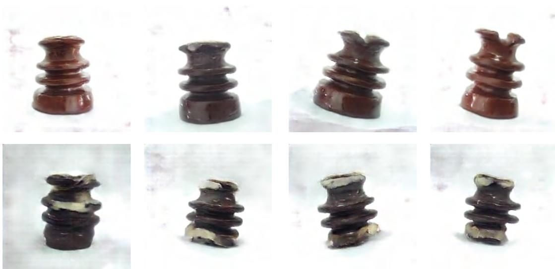
Figura 5.32: Exemplos de imagens de ICP íntegros e defeituosos produzidos pelas cGANs com taxa variável de aprendizagem,  $\lambda_R(\cdot)$ ; componentes íntegros posicionados acima e defeituosos na parte inferior.
