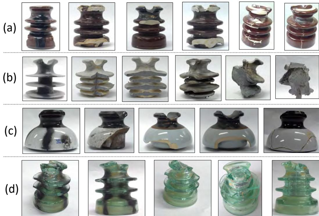
Figura 4.6: Exemplos de componentes defeituosos coletados na ECI: (a) ICP; (b) IPC; (c) ICB; (d) IVV.
