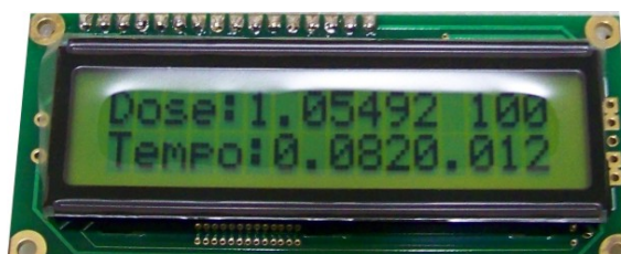
Figura 3.22: Imagem do LCD do protótipo com a visualização da dose medida, tempo medido, o tipo de corrente do tubo selecionado e valor da integração do sinal
