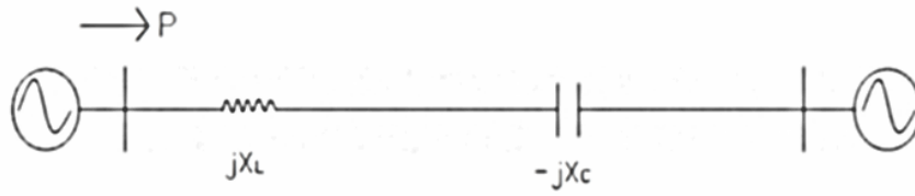
Figura 20. Diagrama Unifilar sistema de compensação em série na transmissão
