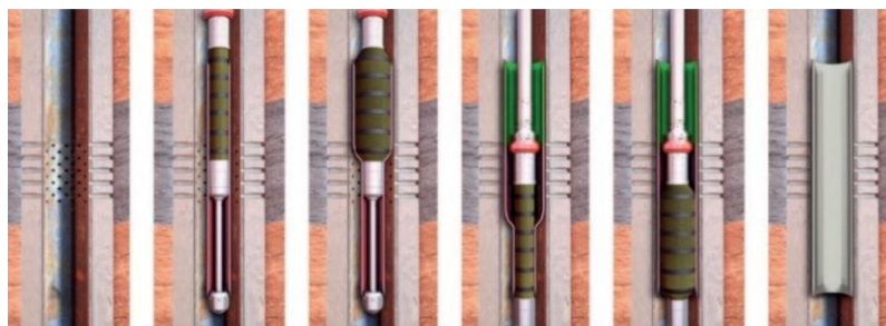
Figura 2.7: Procedimento de aplicação de reparo expandido em um tubo com corrosão interna. Fonte: [15]
