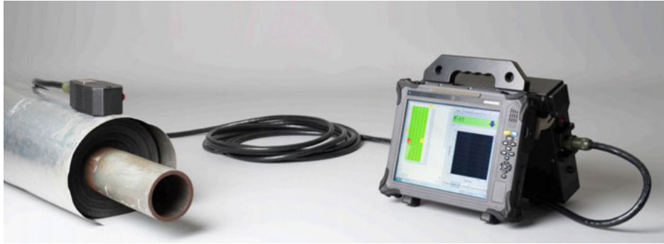
Figura 3.5: Equipamento para ensaios com PEC da fabricante Maxwell ndt . Fonte: [33].
