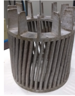
(b) Foto da gaiola de esquilo condutora feita em alumínio.
