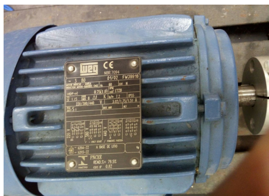
Figura 40 – Motor de Indução Trifásico sob estudo.
