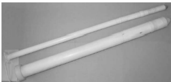
Figura 2.6: Foto dos tubos dos elementos transmissor (tamanho aproximado de 6,00 x 90,00 cm) e receptor (tamanho aproximado de 2,50 x 90,00 cm). Adamo et al. [6]
