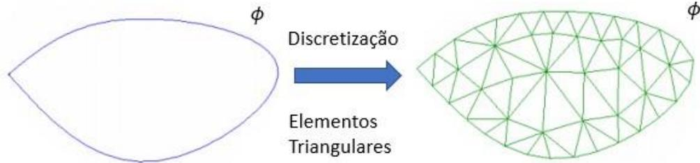
Figura 9 - Discretização de uma região  $\phi$  com elementos triangulares.
