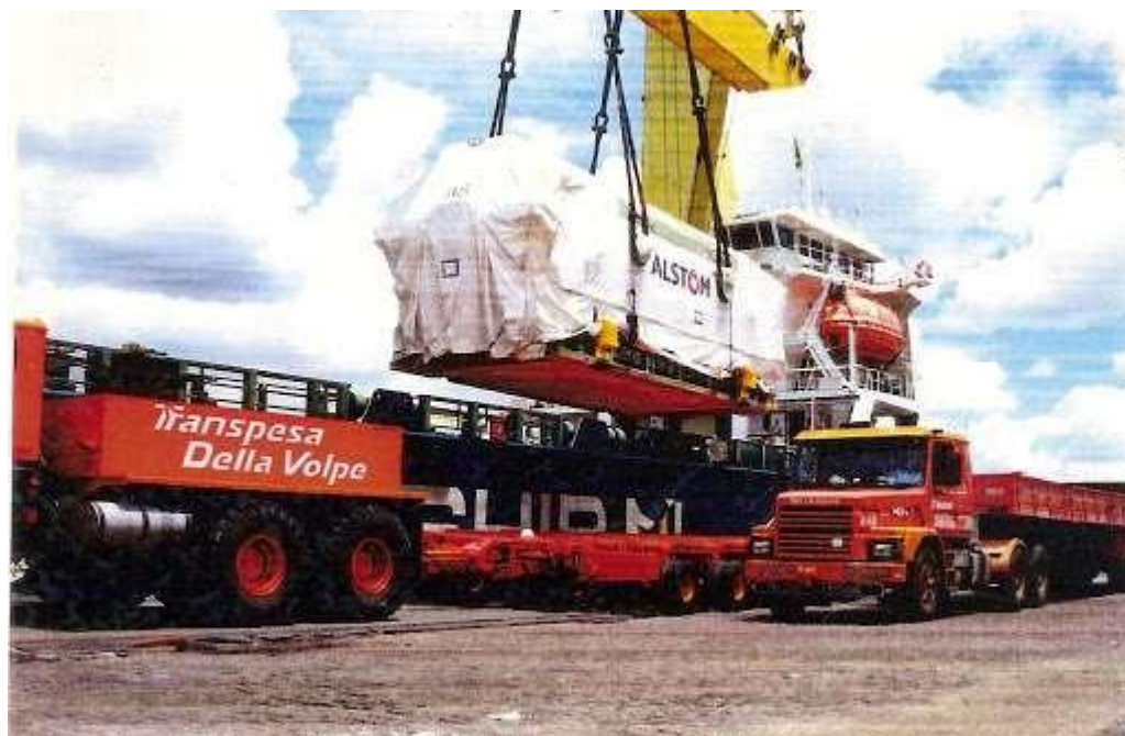
Figura 12 - Transporte do Gerador do Porto de Aratu (2001), em Salvador (BA), para instalação na planta.
