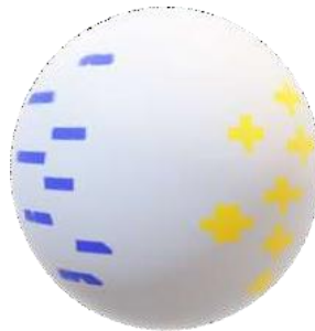
Figura 4 - Representação da distribuição de cargas na cavidade.
