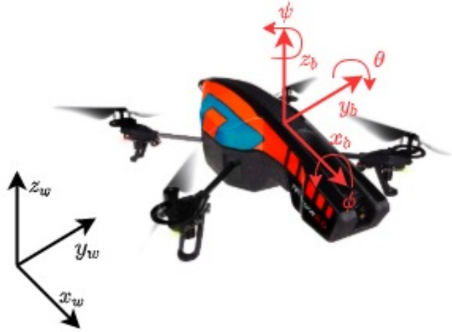
Figura 2.2: Quadrotor modelo AR.Drone 2.0 e os sistemas de coordenadas adotado, sendo \{w\} e \{b\} os sistemas de coordenadas global e do veículo, respectivamente.
