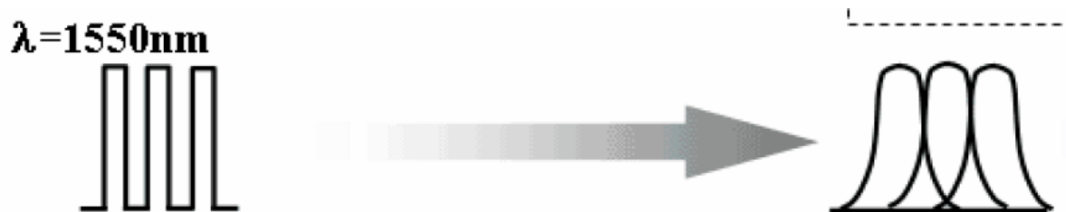
Figura 1.3. Efeito da dispersão: alargamento do pulso após uma determinada distância, limitando a distância do enlace óptico nas fibras.
