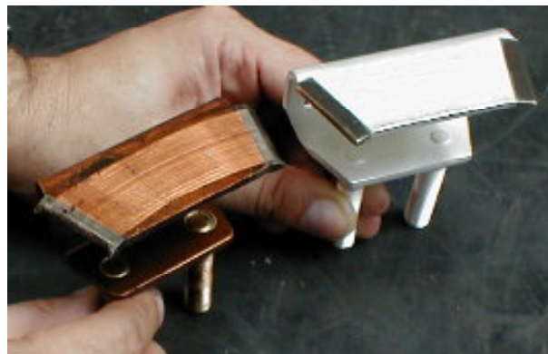
Figura 2.2: Comparação entre um contato desgastado (esquerda) e um contato novo (direita).
