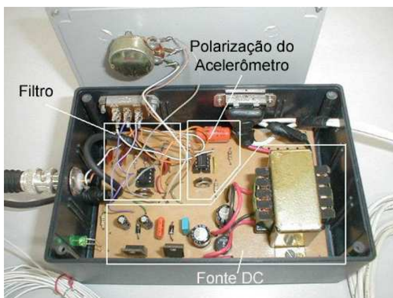
Figura 3.8: Módulo de condicionamento de sinais - circuito.
