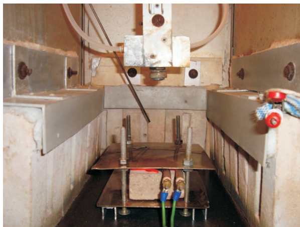
Figura 1.3: Detalhes construtivos da plataforma de pulverização química.
