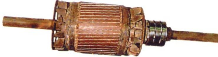
**Figura 2.4 – Rotor de anéis (Guia Operacional de Motores Elétricos PROCEL, CEPEL, ELETROBRAS [04])**
