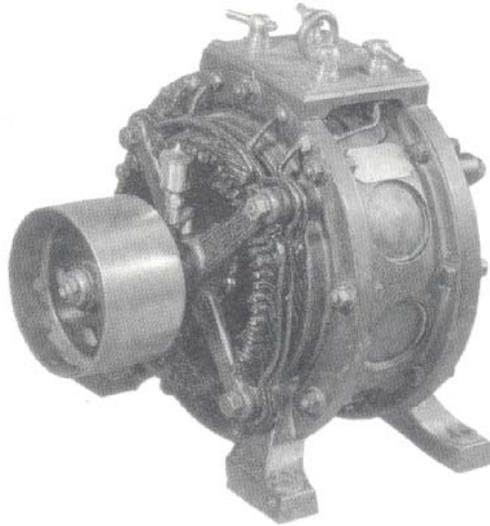
**Figura 2.1- Um dos primeiros motores de indução trifásico (ano 1893)**
